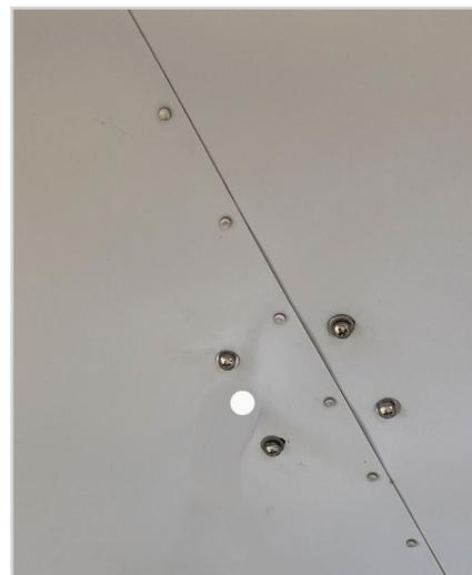
Usando uma broca de 7/16", cuidadosamente faça o furo para o conector da antena.
