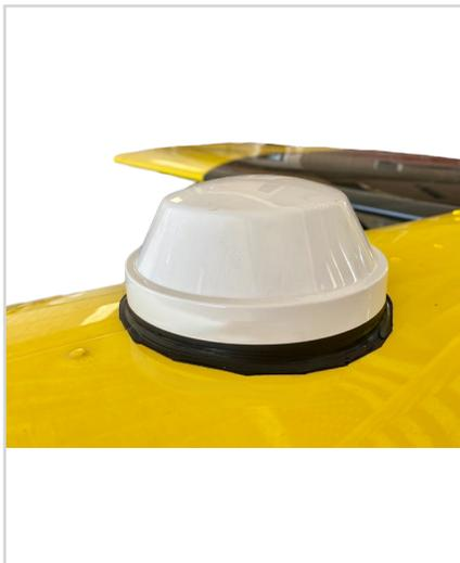
Use quatro parafusos de rosca #8-32 para fixar a antena (PN 804-3036-000#) à superfície da aeronave. O silicone RTV preto pode ser usado para selar ao redor da base da antena. **Uma placa de apoio para reforço pode ser necessária.**
