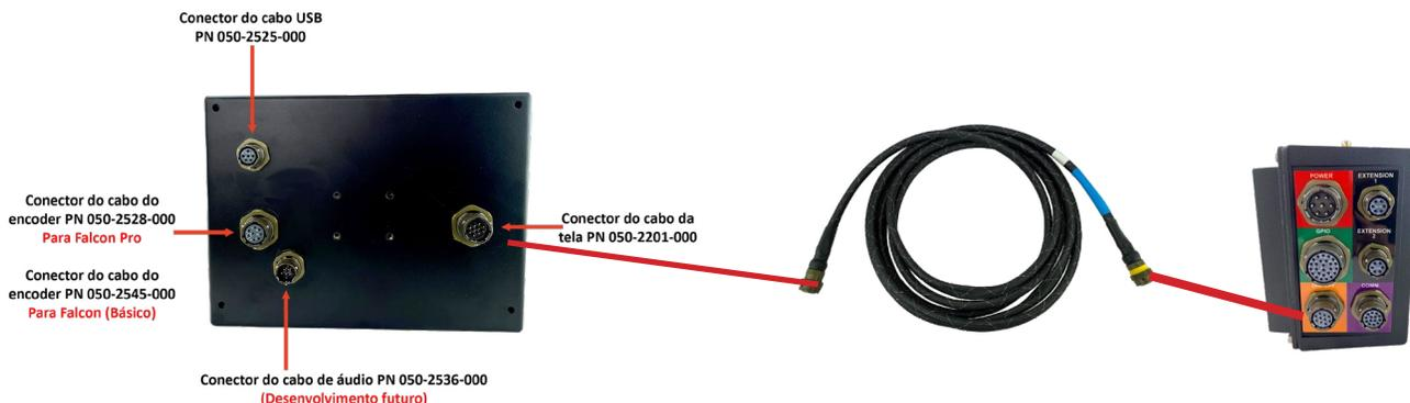
Figura 3-12: Conexões da Cabos da Tela
