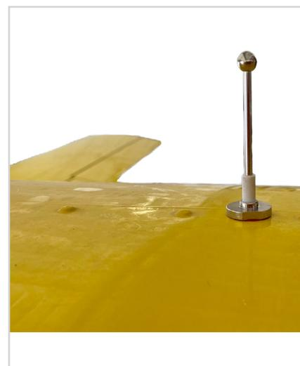
Use o hardware com PN 804-4000-000 para fixar a antena na superfície da aeronave. Conecte o cabo PN 052-2522-000 na antena.
