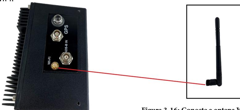
Figura 3-16: Conecte a antena WIFI à CPU Falcon
