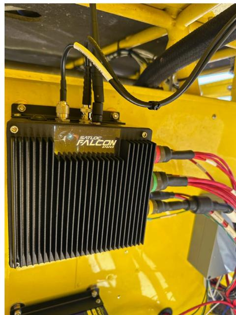
Figura 3-4: Imagem das conexões na parte superior do Falcon
